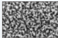
超粗化形状形成 CZシリーズ 銅の表面に独特の凹凸形状をつくり、樹脂との密着性を向上させる超粗化剤。
