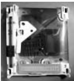
携帯電話に用いられているフレキシブル電子基板
