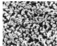
超微細化 CZシリーズ パソコン用MPUパッケージ等の超微細電子基板で、銅表面に独特の凹凸を形成することにより樹脂との密着性を向上。
